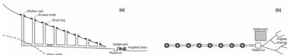
Figure 19. Section transversale et vue d'ensemble d'un système de karez (Source : Kamaz, Z. 2010).
