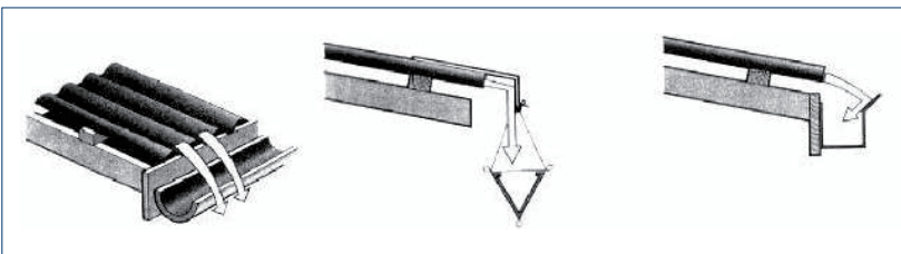
Air melampaui batas talang air (kiri) dan pilihan untuk menghindari luapan air (Skinner, 2003 di Doyle, 2008).
