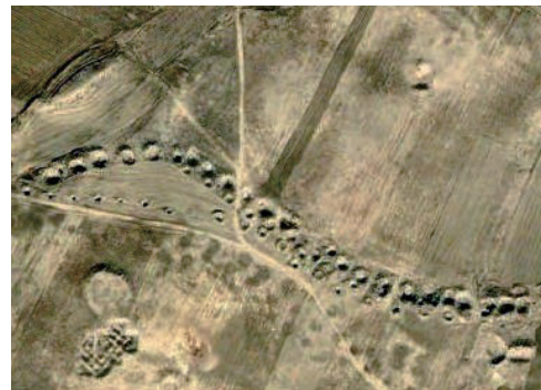
Tampilan udara sistem qanat di Iran dengan poros akses membentuk jalan setapak menuju desa. (www.livius.org)
