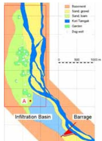
Figura 3: Vista esquemática del área tras la construcción de la barrera
