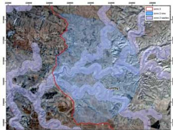
Figura 4: Zonas de protección del agua superficial para el embalse de Wadi Wala (según las líneas directrices de Jordania, la zona 2 para los principales wadis cubre una zona de reserva de agua subterránea de 350 m a ambos lados del centro del wadi)
