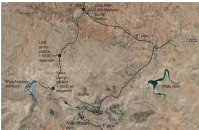
Figura 5: Ubicación de los embalses de Wadi Wala y Wala/Heidan. Campo de captación con red de abastecimiento de agua (las áreas verdes entre el depósito y el campo de captación indican áreas de riego)
