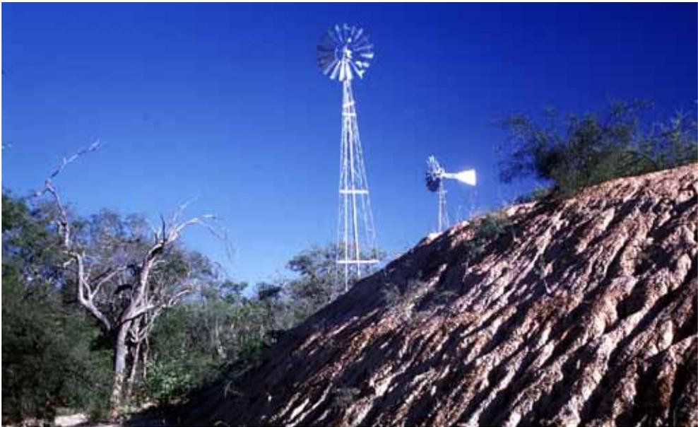
Figura 3: Un molino de viento bombea agua hacia un depósito
